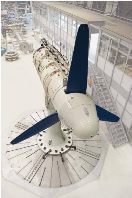
L'hydrolienne HyTide de Voith Hydro © Voith Hydro
