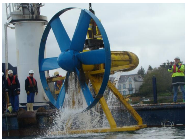
L'hydrolienne pilote D03 de Sabella, modèle précurseur de la future D10 © Sabella
