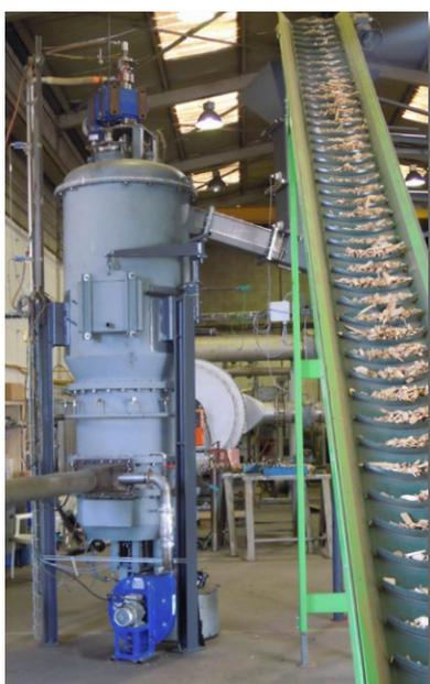
Le brûleur biomasse à gazéification GASCLEAN permet de remplacer un brûleur à combustible fossile sans modification du procédé (chaudière, four, séchoir, ...).
