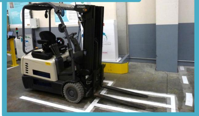
La station permettra d'alimenter une vingtaine de chariots qui ne rejettent que de l'eau. Muni de **piles à combustible à hydrogène** « Hypulsion », ce système apporte une **grande flexibilité** avec une **augmentation du temps d'utilisation** et un **temps de recharge réduit**. Avec une pression de 450 bars, un rechargement prend seulement 3 minutes. Grâce à cette technologie, les batteries n'ont plus besoin d'être manipulées et offrent un **meilleur confort de travail** aux collaborateurs.
