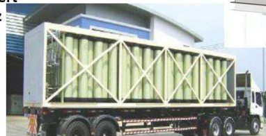
Transport de l'hydrogène sous pression vers les sites de distribution (distance 50 à 100 km)
