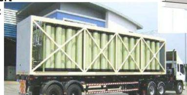
Transport de l'hydrogène sous pression vers les sites de distribution (distance 50 à 100 km)
